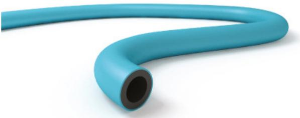
3 strati. Rinforzo retinato. Applicazioni: apparecchiature domestiche e gas. Materiale: prodotto con speciale formulazione che conferisce resistenza al passaggio di GPL. Note: Omologato IMQ. Conforme alle norme UNI/CIG 7140/72. W.P. bar 25 - B.P. bar 75.
