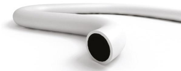
3 strati. Rinforzo retinato. Applicazioni: apparecchiature domestiche a gas. Materiali: prodotto con speciale formulazione che conferisce resistenza al passaggio del Metano. Omologato IMQ. Conforme alle norme UNI/CIG 7140/72. W.P. bar 25 -B.P. bar 75.
